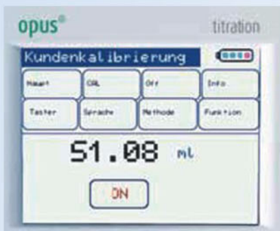
Quicl-cal 校准只需接入数值就可自动完成，直接测量，使校准不再麻烦。
